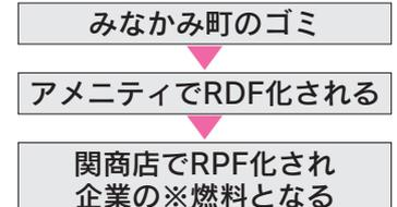
※企業で燃料として使用後に出る RPF の燃えカス（灰）も道路のセメントやアスファルトの材料として最後まで使われている。
