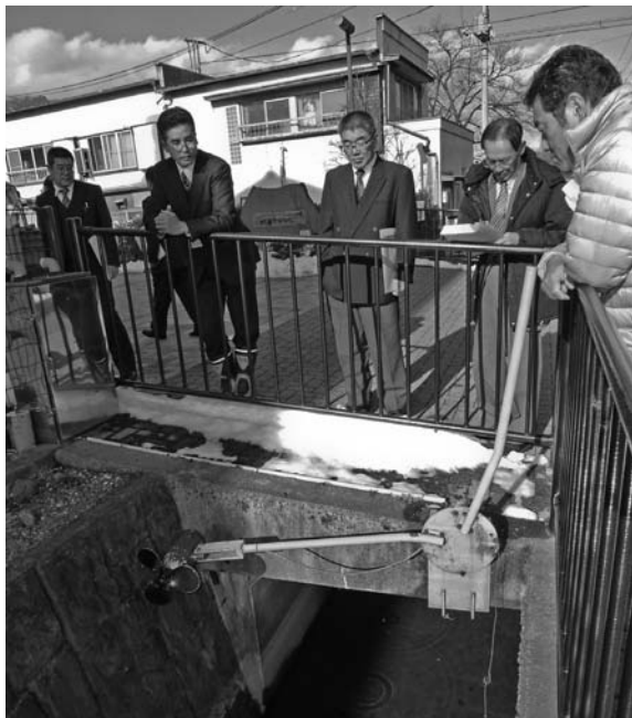
小水力エネルギーの実験機
