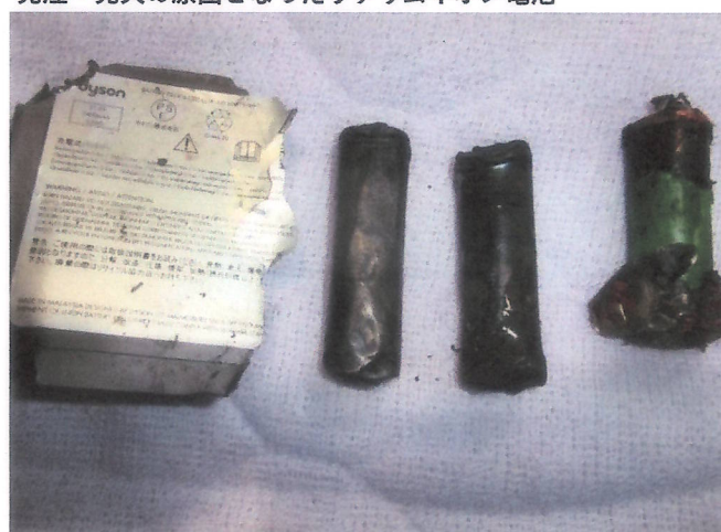
発煙・発火の原因となったリチウムイオン電池
