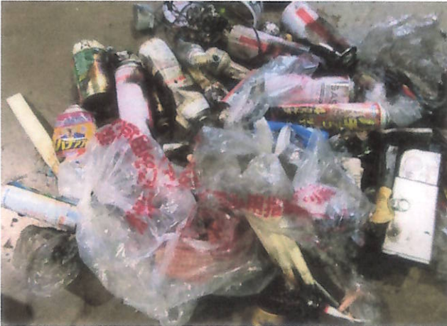
不燃ごみ袋で収集され、ごみピット内で発煙したもの
