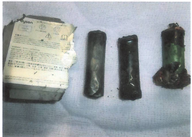
発煙・発火の原因となったリチウムイオン電池
